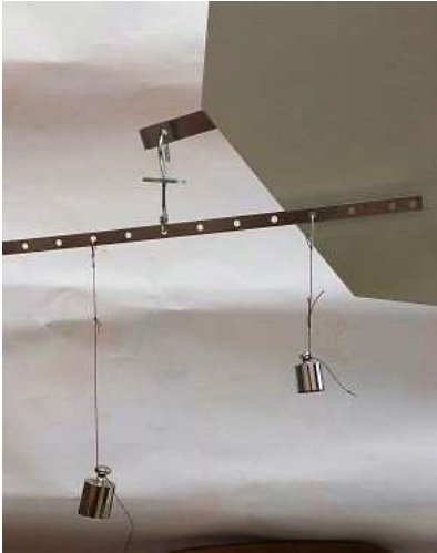
Ricerca della condizione di equilibrio di una leva.
