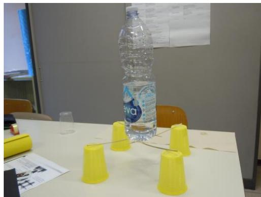
La struttura portante è costituita da 4 bicchieri di plastica e 4 stecchini in legno lunghi: qui sopra la bottiglia contiene un litro d'acqua; in basso a sinistra l'oggetto sostenuto è costituito da un cubetto di legno avente un chiodo di ferro nel centro, sul quale poggia il becco della sagoma di un uccello in policarbonato alveolare.
